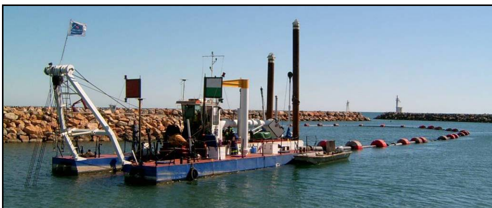
Drague aspiratrice avec conduite de refoulement flottante
